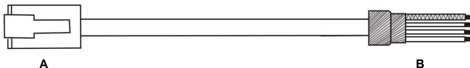
图4.10 伺服驱动器与PLC通讯线缆示意图
