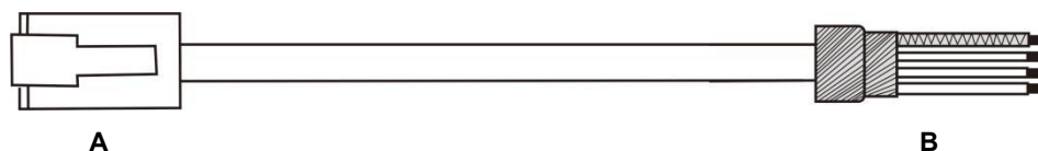
图4.9 伺服驱动器与PLC通讯线缆示意图
